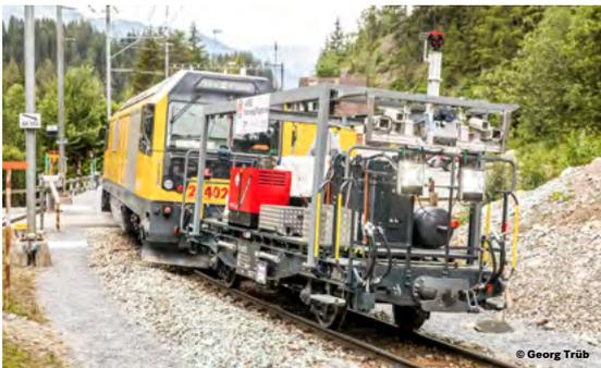
Standardisiertes & kompaktes Messfahrzeug für belastete Messung
